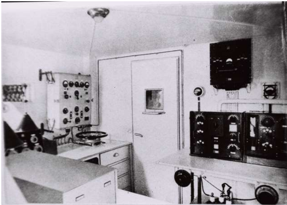
Az LZ127 rádió szobája. Jobbra a fő és mellékadók, balra a telefontájoló, balra az előtérben pedig a telefonvevő-rendszer látható.
