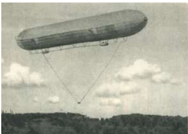
Az L1 Poppe cikkéből a stabilizáló súllyal
